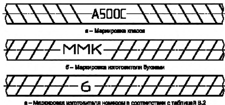
Рисунок В.1 — Маркировка проката надписью
